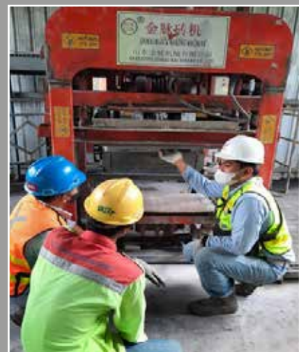
Pelatihan alat produksi batako dan produk yang menggunakan FABA di EPN Training on brick production equipment and products using FABA at EPN
