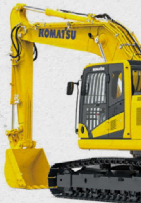
alat berat berbasis nirkabel dari Komatsu yang dapat diakses di mana pun dan kapan pun melalui perangkat komputer maupun telepon seluler. Cara kerja *electric excavator* ini menggunakan tenaga listrik untuk melakukan penggalian dan pemindahan material.
